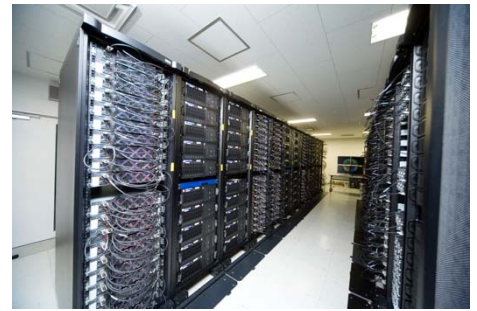
図 3 : 理化学研究所開発の分子動力学シミュレーション計算専用計算機 MD-GRAP E 3。
